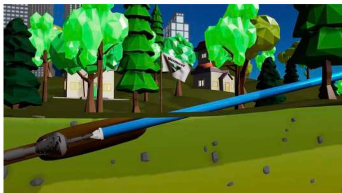
**CON DEI GANCI FOLLI,** si collega l'alesatore alla conduttura o fascio di tubi da posare e si ritraggono le aste verso la macchina all'interno del foro pilota allargato all'alesatore.
