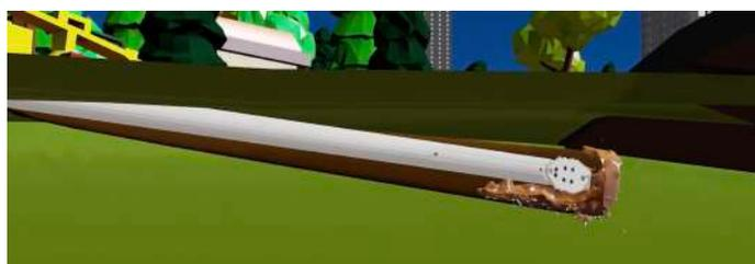
**GUIDA:** Per guida si intende il controllo della direzione del percorso di perforazione. La forma del coltello di taglio permette all'operatore di cambiare la direzione durante la perforazione. Quando l'operatore dirige
