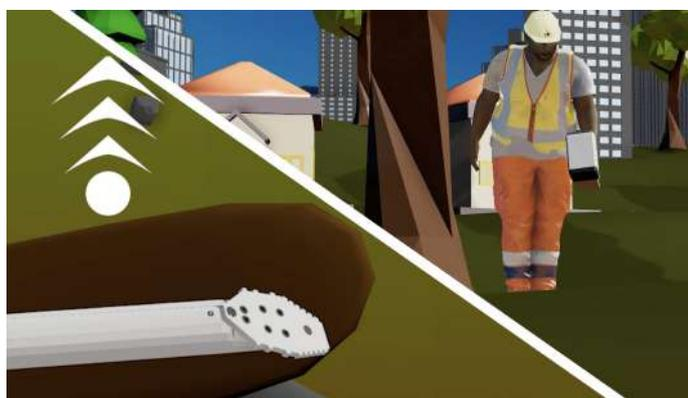
**FLUIDO DI PERFORAZIONE:** La miscela che crea il fluido è composta di acqua e additivi naturali che vengono pompate attraverso le aste e la testa di perforazione (o l'alesatore).
